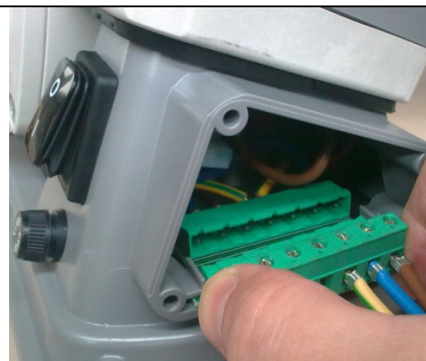
Insérer le connecteur et fermer le couvercle presse-câbles.
