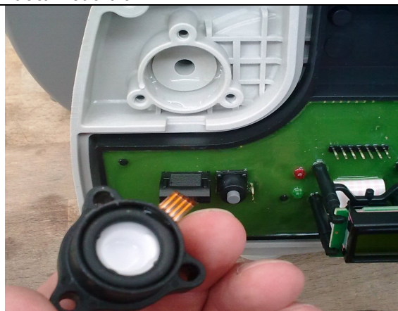
Замените датчик давления и установите его заново.
