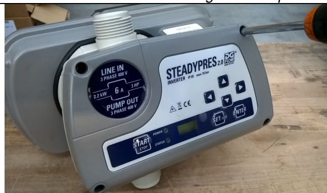
Abrir la tapa anterior desenroscando los 4 tornillos.
