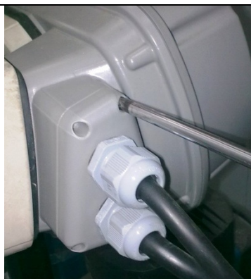
Ouvrir le couvercle latéral presse-câbles (4 vis)
