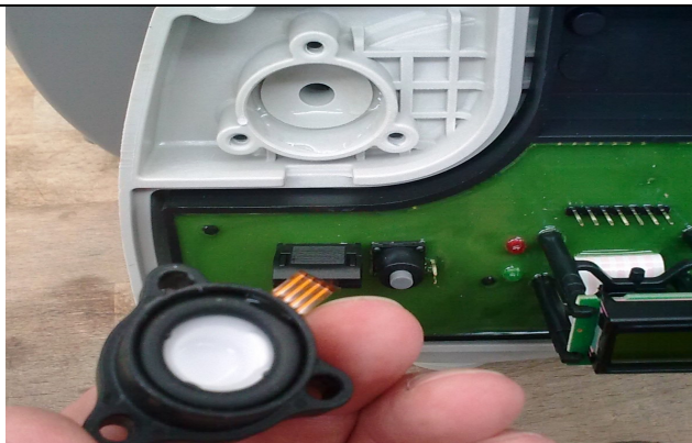
Einen neuen Drucksensor anbringen.
