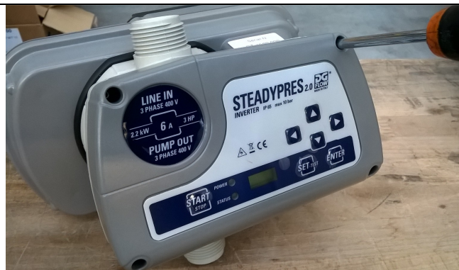
Aprire il coperchio anteriore svitando le 4 viti
